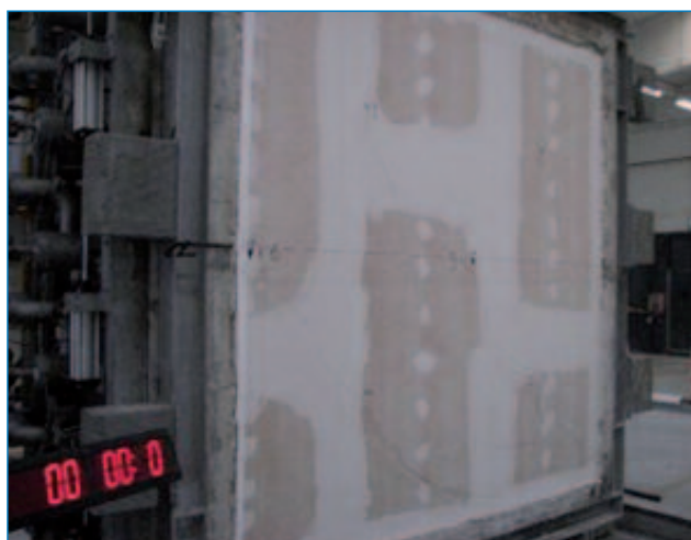
Lato non esposto al fuoco prima della prova
