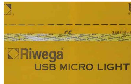
**USB MICRO LIGHT** è uno schermo freno al vapore impermeabile all'acqua ed all'aria a tre strati; gli strati superiore ed inferiore sono rappresentati da tessuti non tessuti in polipropilene che vanno a proteggere il film microporoso centrale a bassa traspirazione in polipropilene. I tre strati vengono accoppiati e saldati tra loro tramite termosaldatura.
