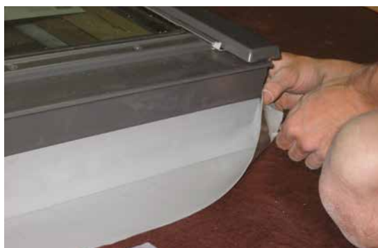
3. Togliere il liner sottostante prima nella parte superiore e poi in quella inferiore
